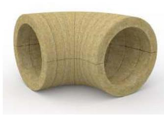
ProRox SB 960 ist ein vorgeformter Rohrbogen aus Steinwolle, der aus Segmenten zusammengesetzt ist, die aus der Rohrschale geschnitten sind. Die Segmente sind mit Kleber miteinander verbunden.
