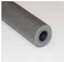
**Produkt:** flexibler, extrudierter Isolierschlauch aus Polyethylenschaum geschlossenzellig, angeschlitz, gefertigt nach EN 14707
