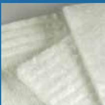
Nadelmatten werden ohne Zugabe von Bindemitteln aus Fasern hergestellt. Dies erfolgt in einem rein mechanischen Verfahren wodurch Nadelmatten hoch resistent gegen eine Vielzahl von Säuren sind und eine Temperaturbeständigkeit von bis zu 1300 °C aufweisen.
