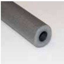
**Produkt:** flexibler, extrudierter Isolierschlauch aus Polyethylenschaum geschlossenzellig, angeschlitz, gefertigt nach EN 14707
