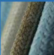
Quadratisch, rund oder rechteckig geflochtene Packungen und Schnüre werden als Dichtungselemente bei hohen thermischen Anforderungen, z.B. im Kessel und Ofenbau eingesetzt. Die Anwendungsgrenztemperaturen liegen bei 1000 °C.
