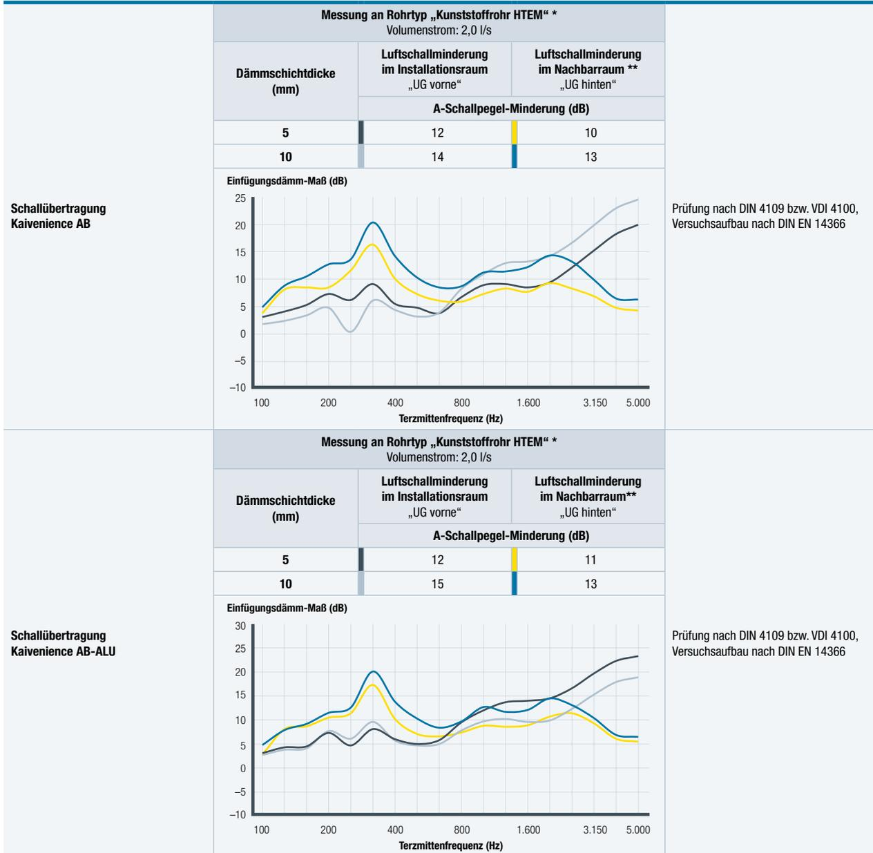
\* Alle Ergebnisse wurden ohne weitere Abschirmung, z. B. Gipskartonplatte, ermittelt. Die Referenzmessung zur Ermittlung der Luftschallminderung im Nachbarraum erfolgte am Abwassersystem ohne Rohrummantelung im Deckendurchbruch mit Mörtel vergossen.
